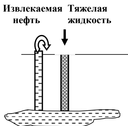
Рис. 6.22. Схема извлечения нефти
