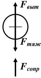
Рис. 6.40. Схема сил, действующих на частицу в процессе ее осаждения
