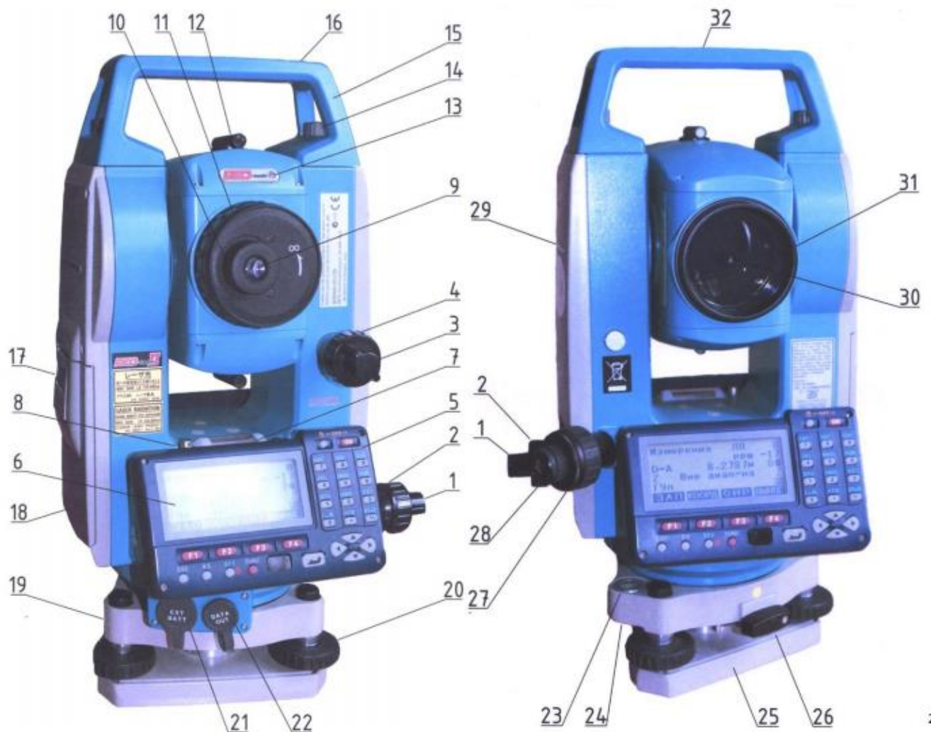
Рис.1 – Внешний вид электронного тахеометра Sokkia SET530 RK-3
