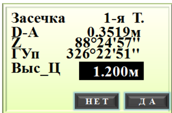
Рис. 23 – Подтверждение измерений при высотной привязке
