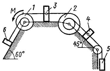
Пренебрегая трением, найти ускорение тела, имеющего больший вес; веса  $P_1, \dots, P_6$  шкивов и грузов заданы в таблице. Грузы, веса которых равны нулю, на чертеже можно не изображать (шкивы 1, 2 изображать всегда как части системы).
