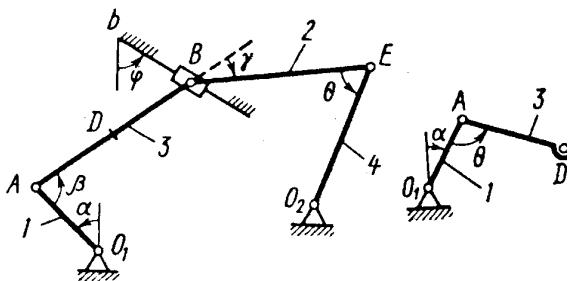
Дуговые стрелки на рисунках показывают, как при построении чертежа механизма должны откладываться соответствующие углы: по ходу или против хода часовой стрелки..
