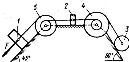
Определить значение искомой величины в тот момент времени, когда перемещение  $s$  станет равным  $s_1$ . Искомая величина указана в столбце «Найти» таблицы Д1, где обозначено:  $v_1$ ,  $v_2$  и  $v_{C3}$  – скорости грузов 1, 2 и центра масс тела 3 соответственно,  $\omega_4$  и  $\omega_5$  – угловые скорости тел 4 и 5.
