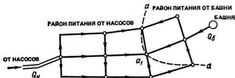
Рис. 12. Схема водоснабжения с контррезервуарами.
