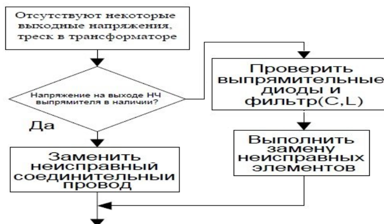
Рис. 36. Алгоритм поиска неисправностей в блоке питания ПК в случае неотличия выходных напряжений от номинала
