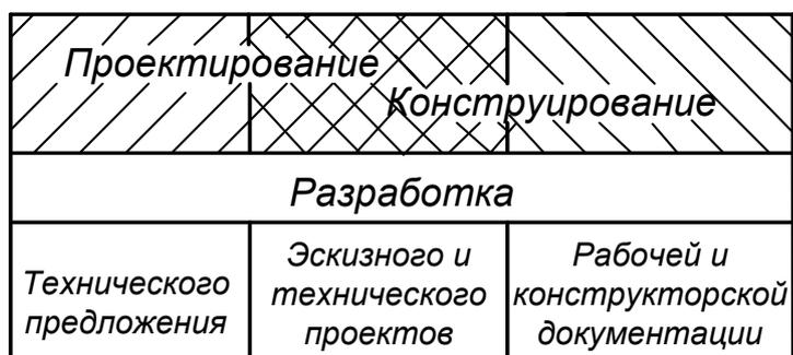
Рис. 1.1. Схема взаимосвязи процессов проектирования и конструирования
