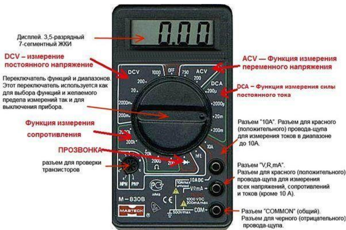
Рисунок 13 – Расположение органов управления мультиметра серии 830-832
