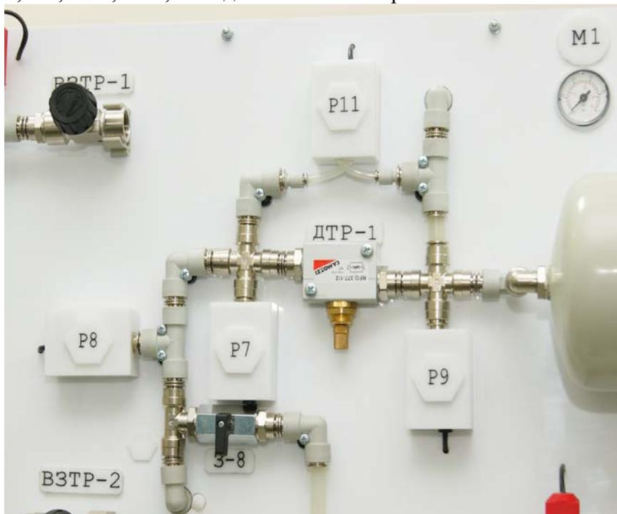
*Рис. 3. Участок исследования потерь на местном сопротивлении – регулируемом дросселе 2 и участок изучения приборов и методов определения давления.*
