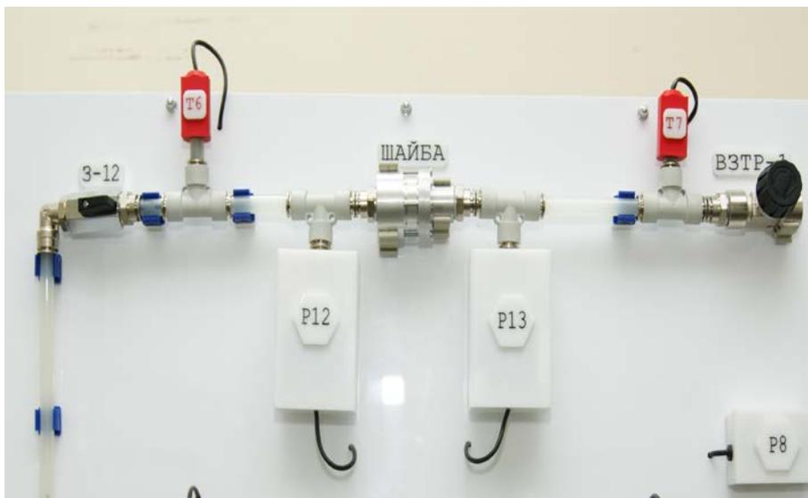
*Рис. 6. Участок исследования потерь напора на местном сопротивлении – диафрагме.*
