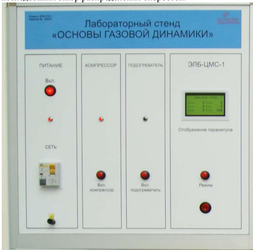
*Рис. 10. Блок управления включения стенда, подогревателя, вентилятора и компрессора.*
