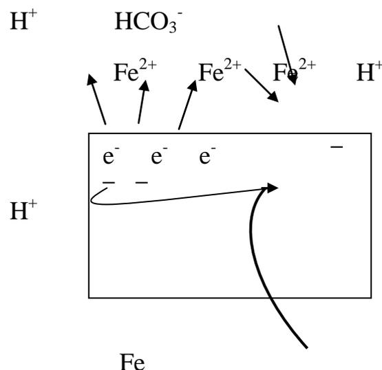
Схема электрохимической коррозии железа в кислой среде
