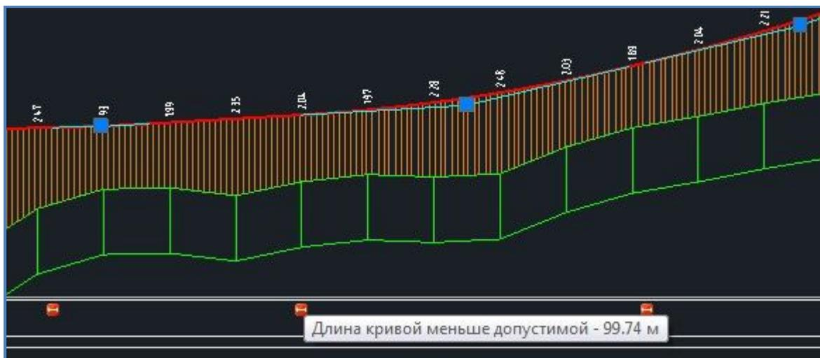
Рис.3.14. Элемент, обозначающий несоответствие параметров нормативным значениям
