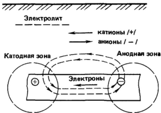
Рис. 1.1 Процесс электрохимической коррозии
