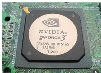
Рис. 1.7. Графический процессор nVidia GeForce 3 Ti 200
