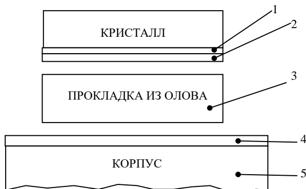
Рис. 2.5. Схема бессвинцовой пайки кристалла к корпусу: 1 – Al (2 мкм); 2 – Zn (4 мкм); 3 – Sn (46 мкм); 4 – Ni (3-4 мкм); 5 – Cu (корпус)
