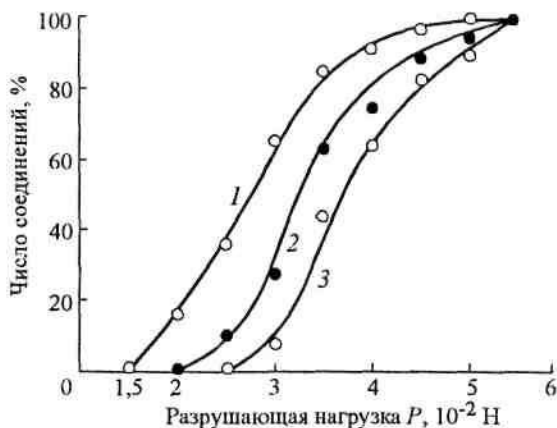
Рис. 3.13. Интегральное распределение прочности микросварных соединений алюминиевых микропроводников с различными вакуумно-осажденными пленками алюминия (номера кривых соответствуют номерам партий кристаллов)
