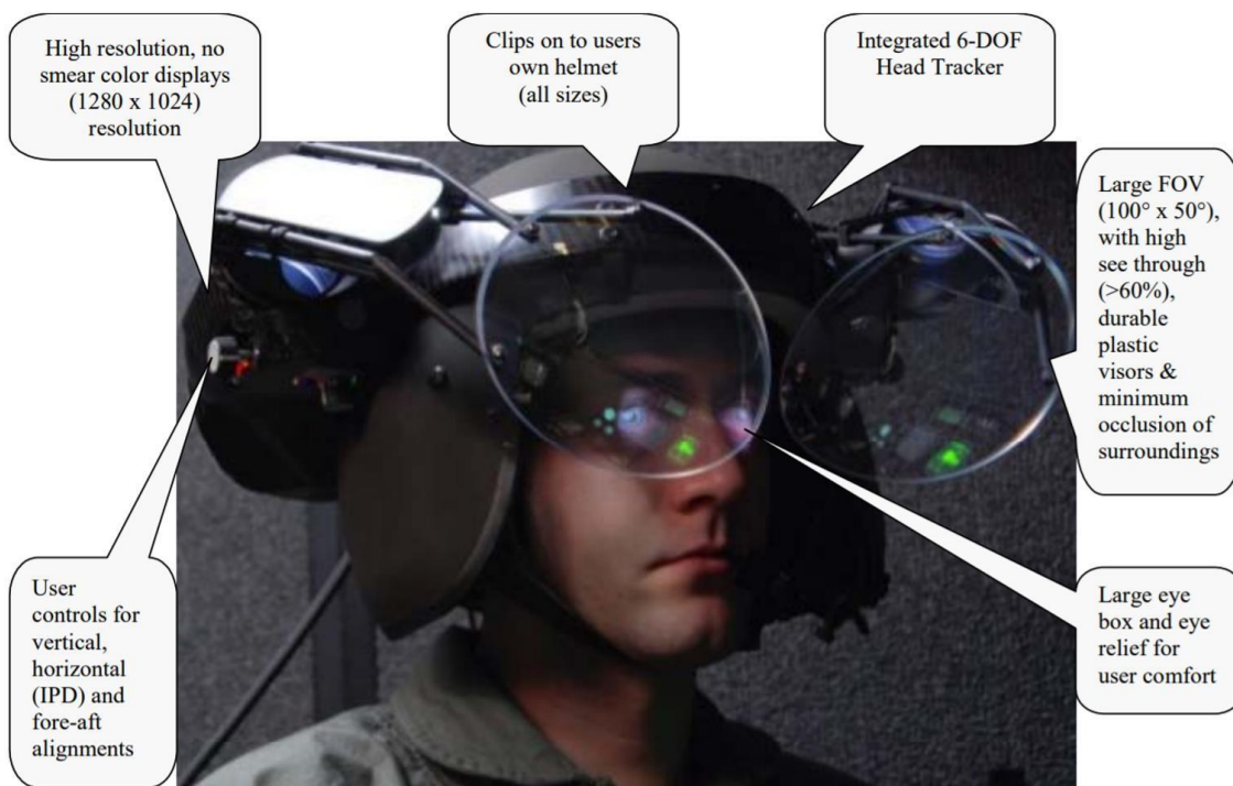
Рис. 6. Оптическая система нашьлемного индикатора
