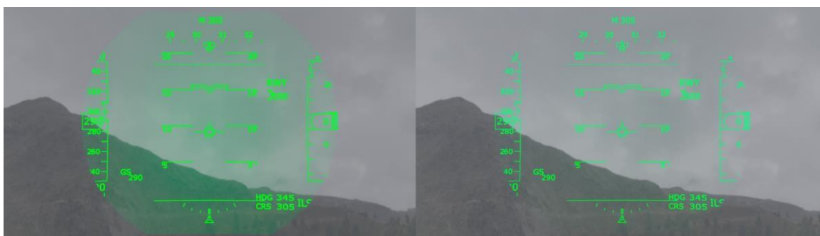
Рис. 17. Изображения, видимые на индикаторе на лобовом стекле реальных условиях
