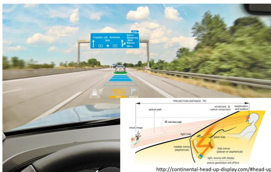
Рис. 4. Принцип работы оптической части индикатора на лобовом стекле
