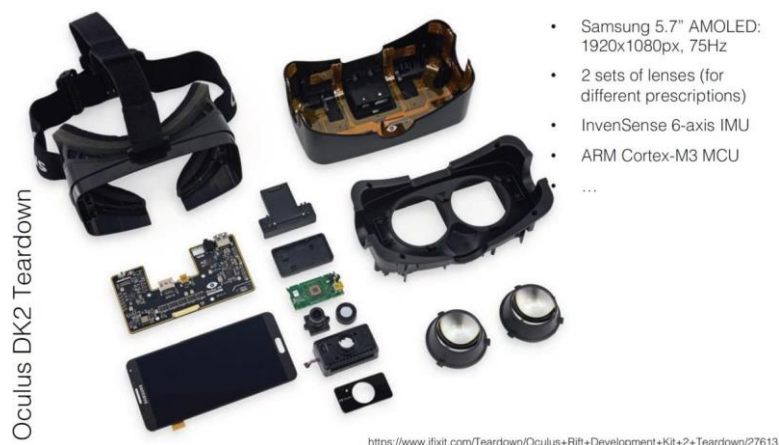
Рис. 3. Компонентная база очков виртуальной реальности
