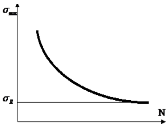
Рис.2.12. Кривая усталости (кривая Веллера)
