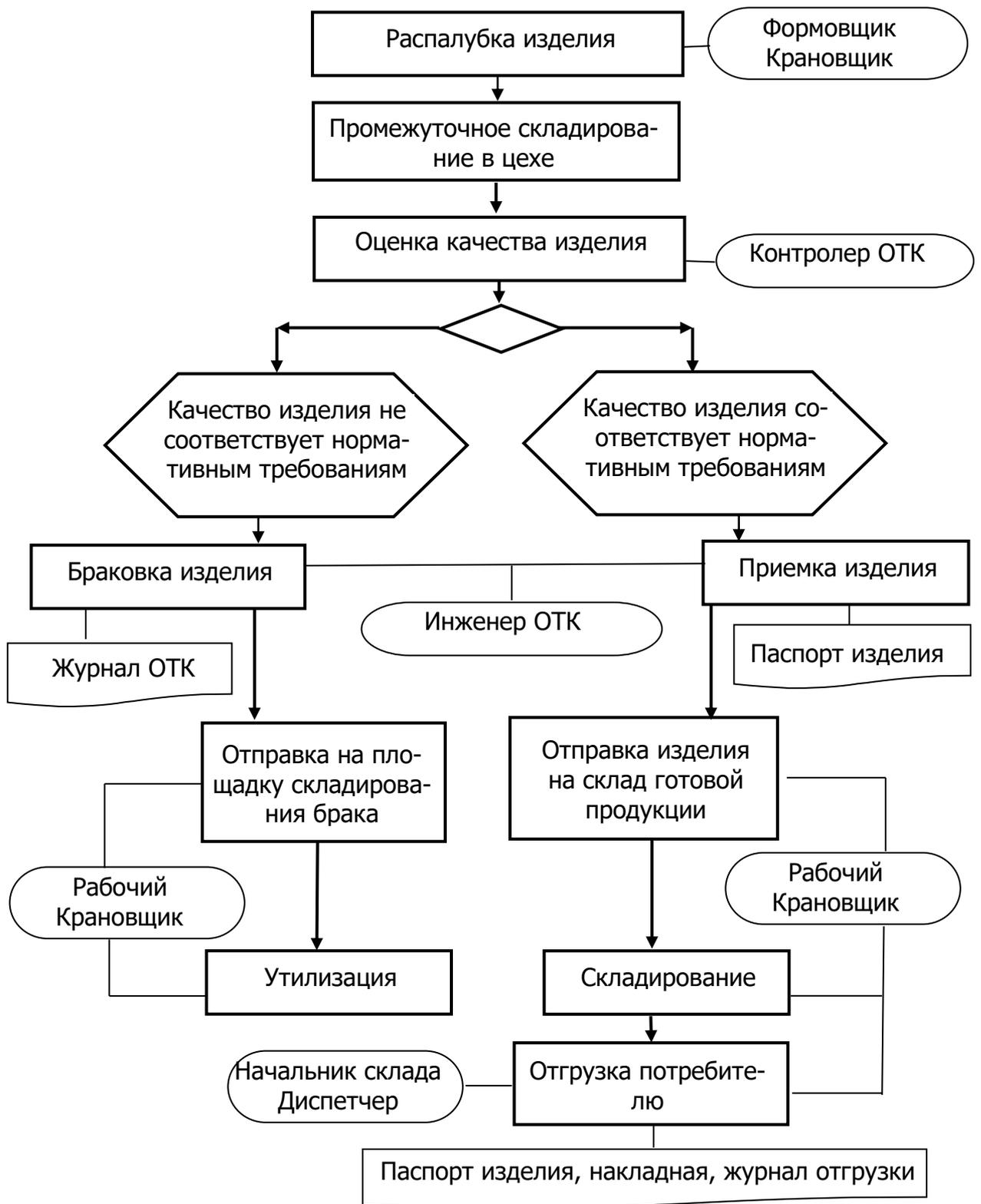
Рис. 7. Пример алгоритма процесса приемки и складирования железобетонного изделия
