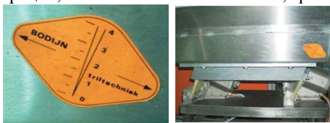
Рис. 2.3. Установка мерного клина для измерения амплитуды колебания вибрационного дозатора
