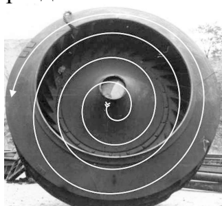
Рис. 2.6. Эксцентрисический способ осмотра детали
