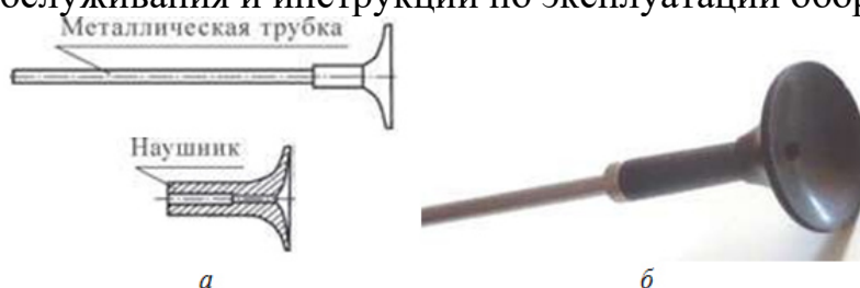
Рис. 2.1. Технический стетоскоп: а) схема; б) общий вид
