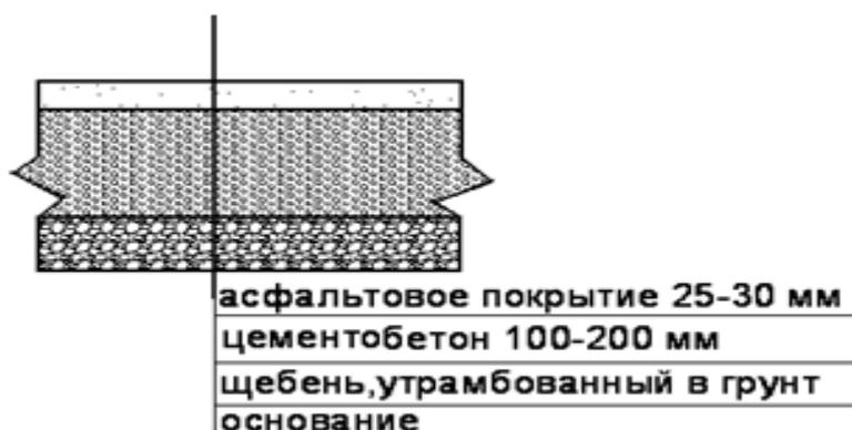
**Рис. 14.4.** Схема пола с асфальтовым покрытием
