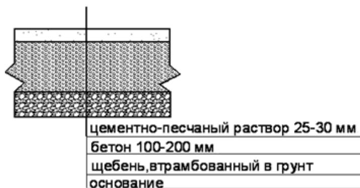
**Рис. 14.1.** Схема устройства цементно-песчаных (бетонных) полов по грунтовому основанию
