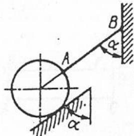
Однородный шар весом 12 Н удерживается в равновесии на гладкой наклонной плоскости с помощью веревки  $AB$ . Определить давление шара на плоскость, если угол  $\alpha = 60^\circ$ .
