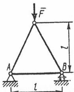
Определить усилие в стержне  $AB$ . Сила  $F = 400 \text{ Н}$ .
