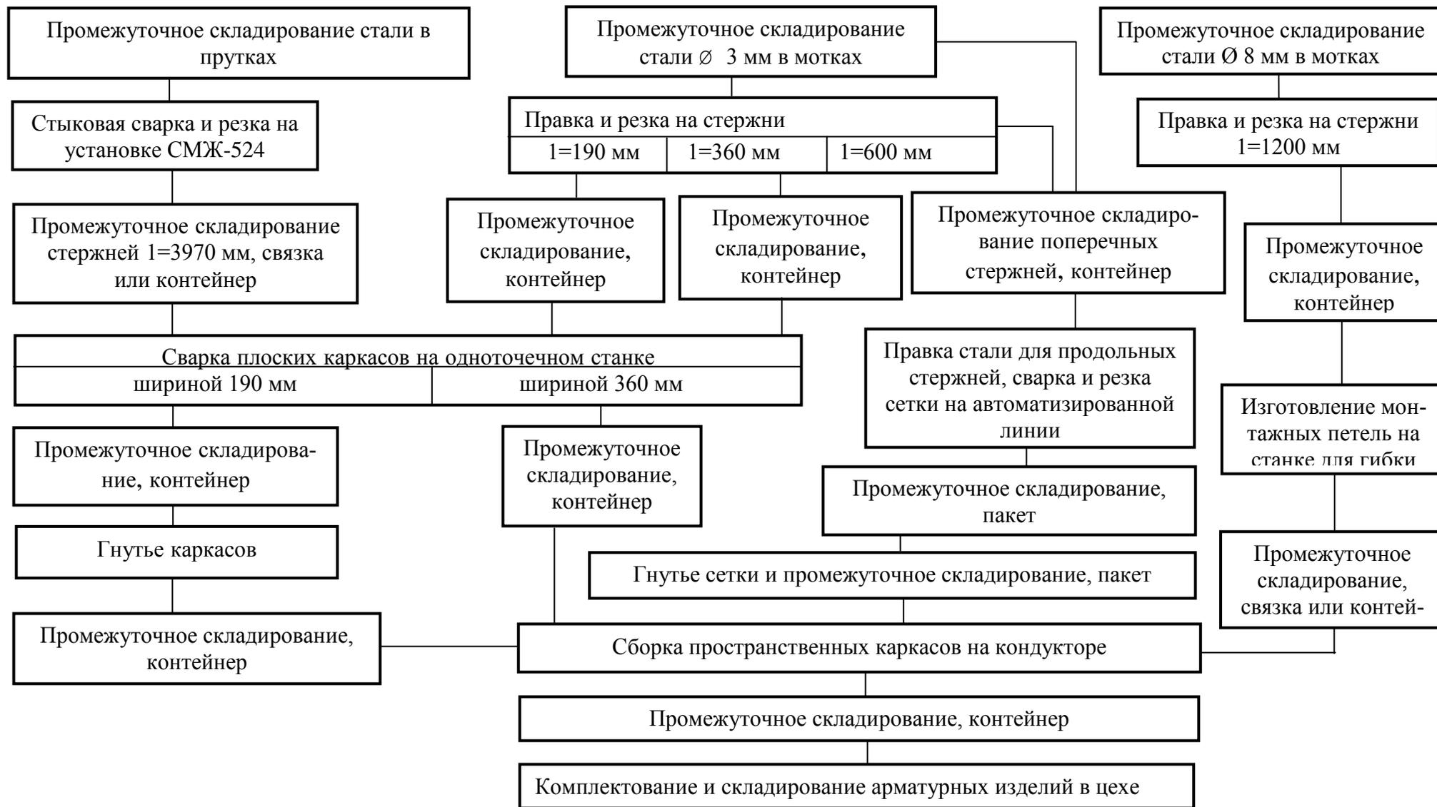
Рисунок 6 - Пример пооперационной технологической схемы производства арматурных изделий для железобетонной конструкции
