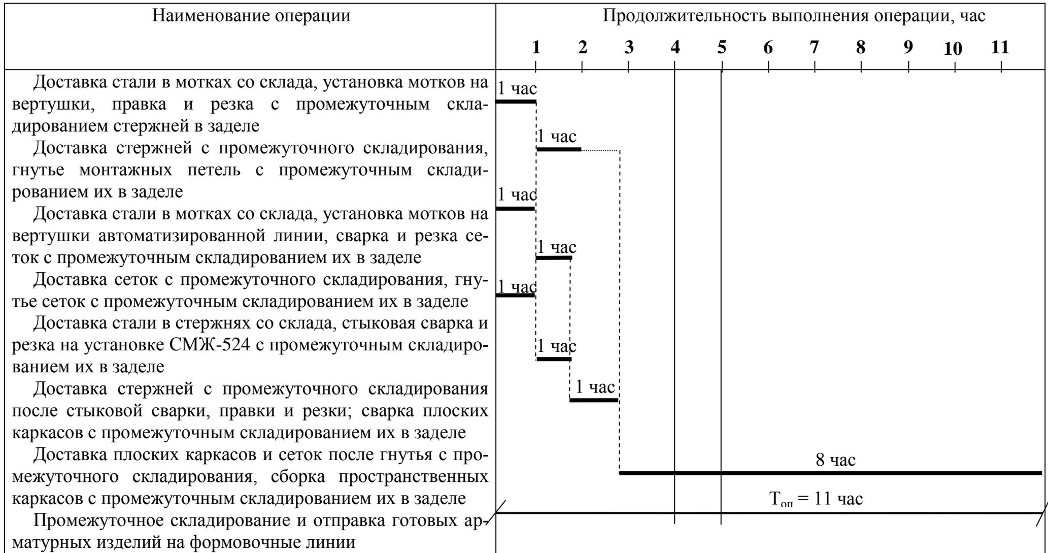
Рисунок 9 – Пример циклового графика изготовления одной партии арматурных изделий ( $R = 1$  час)
