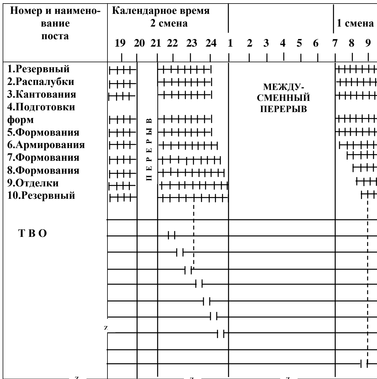
Рис.13. Пример участка графика производственного процесса изготовления наружных стеновых панелей конвейерным способом с ритмом 20 мин
