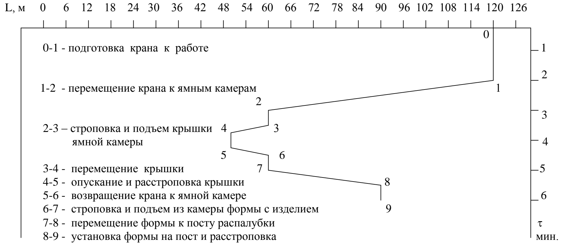
Рис.17. Пример составления циклограммы работы мостового крана
