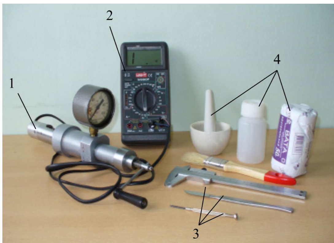
Рис. 2.2. Фото комплекта «Пресс» для исследования обугленных остатков древесины: 1 — гидравлический микропресс; 2 — электрический мультиметр; 3 — оборудование для пробоотбора; 4 — оборудование для пробоподготовки [3]
