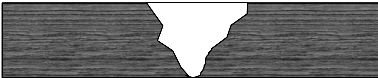
Рис. 1.8. Графическое изображение сквозного прогара в деревянной конструкции
