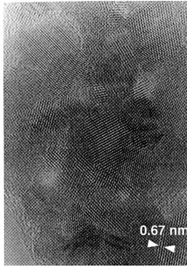
Рис. 2.26. Микрофотография электронной микроскопии высокого разрешения пленки \text{SnO}_2 , легированной сурьмой, после лазерной термообработки [160]
