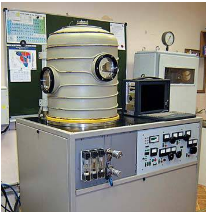
Рис. 2.6. Модернизированная установка магнетронного распыления УВН-2М
