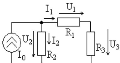
10. Построить модель цепи постоянного тока. В режиме «Анализ, расчет по постоянному току» провести моделирование мощностей, потребляемых от источника и в сопротивлениях.
