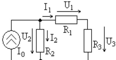
9. Построить модель цепи постоянного тока. В режиме «Анализ, расчет по постоянному току» провести моделирование токов в цепи.
