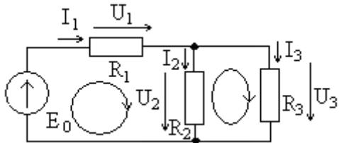
2. Определить количество узлов на схеме: (q=2)
