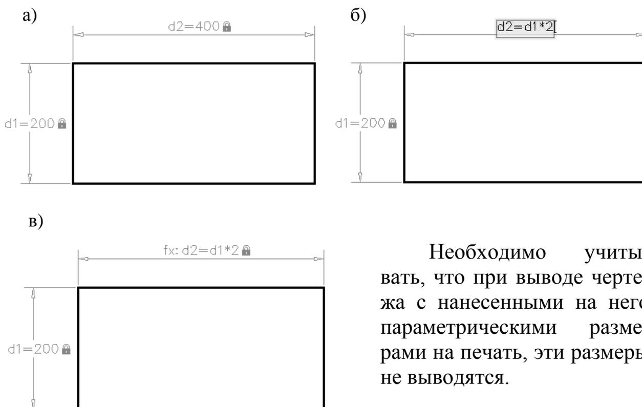
Необходимо учитывать, что при выводе чертежа с нанесенными на него параметрическими размерами на печать, эти размеры не выводятся.
