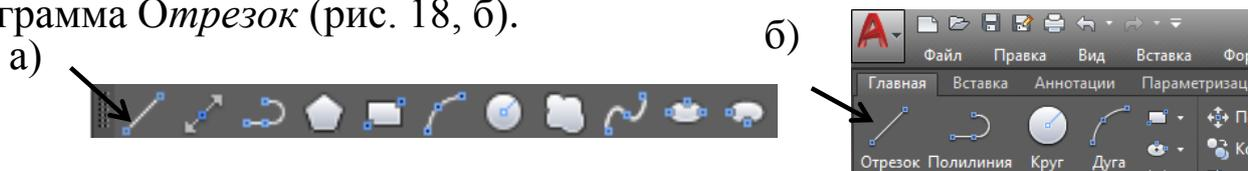
**Рис. 18.** Пример вызова команды *Отрезок* из *Панели инструментов* (а) и *Ленты* (б)
