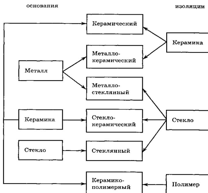
Рис. 10.1. Классификация корпусов ИМС
