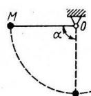
Материальная точка  $M$  массой  $m$  подвешена на нити длиной  $OM = 0,4 \text{ м}$ , отведена на угол  $\alpha = 90^\circ$  и отпущена без начальной скорости. Определить скорость точки в нижнем положении. (2,8 м/с)
