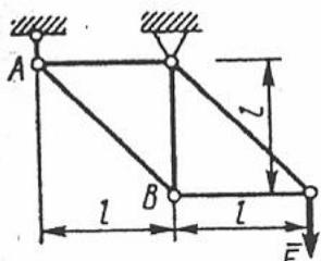
Определить усилие в стержне  $AB$ . Сила  $F = 300 \text{ Н}$ .
