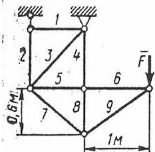
Определить усилие в стержне 5. Сила  $F = 480 \text{ Н}$ .
