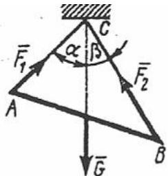
Определить вес балки  $AB$ , если известны силы натяжения веревок  $F_1 = 120$  Н и  $F_2 = 80$  Н. Заданы углы  $\alpha = 45^\circ$  и  $\beta = 30^\circ$  между вертикалью и веревками  $AC$  и  $BC$  соответственно.
