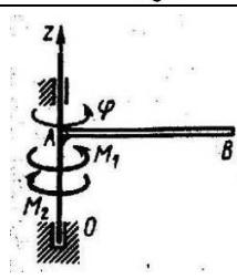
Однородный стержень, масса которого  $m = 2 \text{ кг}$  и длина  $AB = 1 \text{ м}$ , вращается вокруг оси  $Oz$  под действием пары сил с моментом  $M_1$  и момента сил сопротивления  $M_2 = 12 \text{ Н}\cdot\text{м}$  по закону  $\varphi = 3t^2$ . Определить модуль момента  $M_1$  приложенной пары сил в момент времени  $t = 1 \text{ с}$ .
