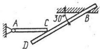
Однородный горизонтальный стержень  $AC$ , вес которого равен  $180 \text{ Н}$ , свободно опирается в точке  $C$  на балку  $BD$ . Определить реакцию балки  $BD$  на стержень  $AC$ .
