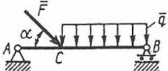
На балку  $AB$  действуют распределенная нагрузка интенсивностью  $q = 2$  Н/м и сила  $F = 6$  Н. Определить реакцию опоры  $B$ , если длина  $AC = 1/3 AB$ , угол  $\alpha = 45^\circ$ .  $AB = 3$  м.
