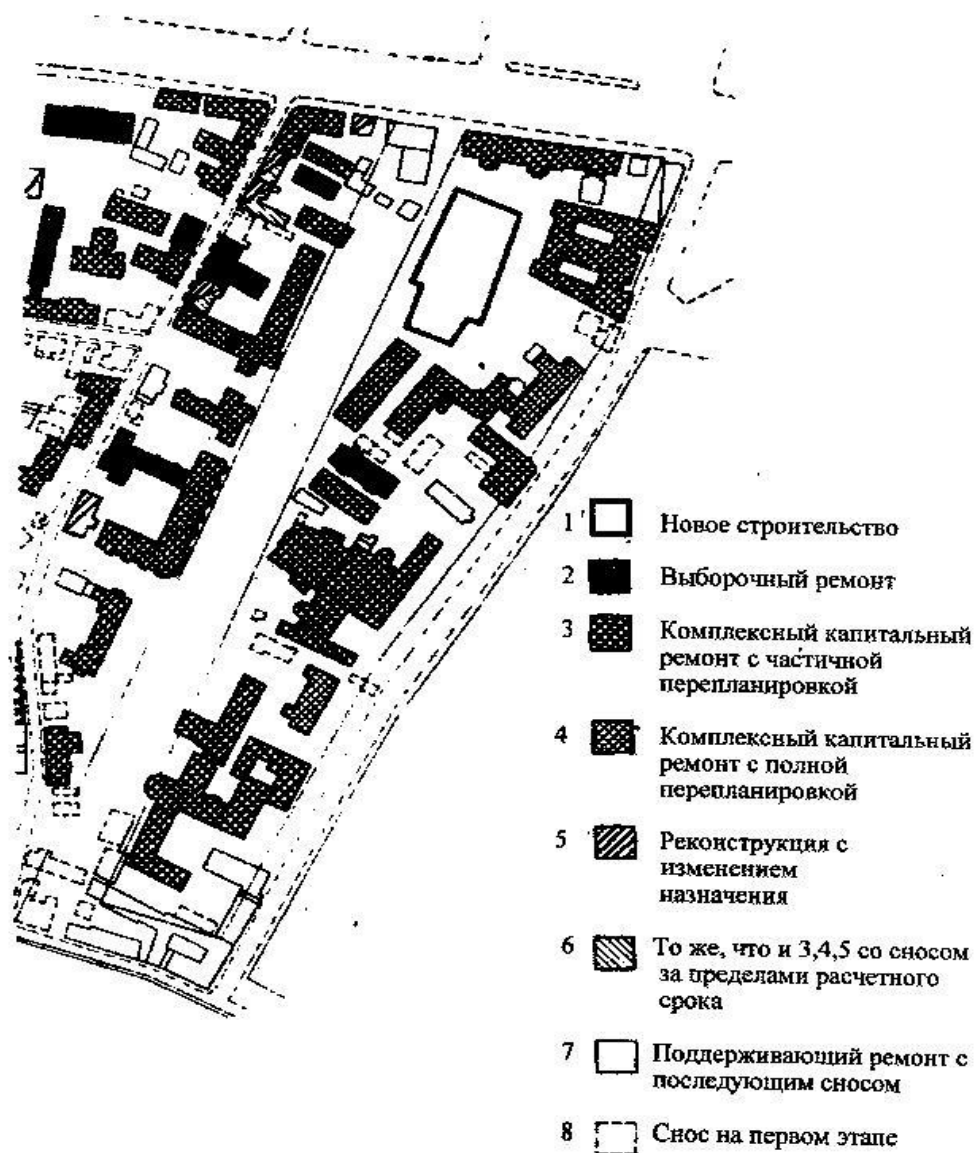
Рис. 7. Картограмма рекомендаций о необходимости реконструкции, капитального ремонта или сноса зданий
