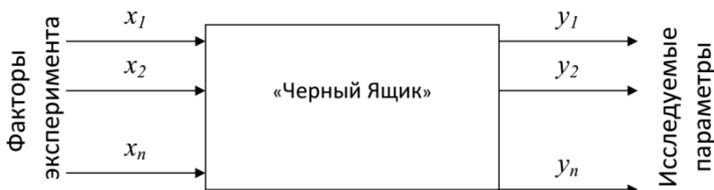
Рис. 4.1. Представление объекта исследования в виде «черного ящика»:  $X$  - входные (управляющие) параметры (факторы);  $Y$  - выходные параметры (параметры оптимизации)
