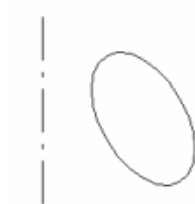
Рис. 3. Эскиз для создания тора
