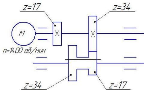
8. Пользуясь рисунком, напишите уравнения кинематического баланса для максимальной частоты вращения выходного вала коробки скоростей, определите максимальную частоту вращения
