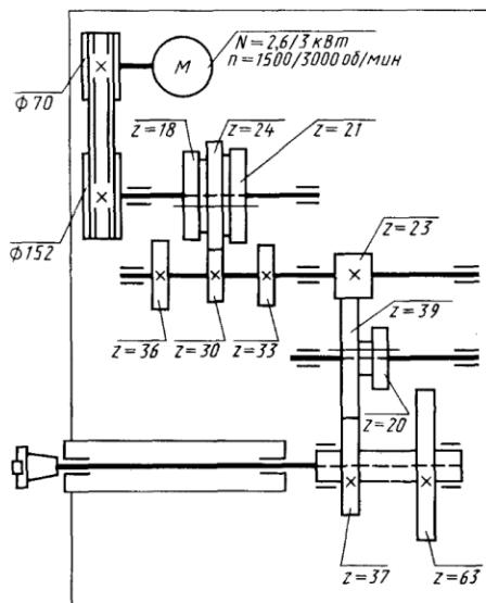
14. Напишите уравнение кинематического баланса для минимальной частоты вращения шпинделя
