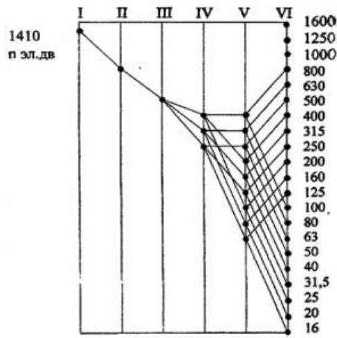
11. Определите по рисунку сколько передач в коробке скоростей, как изменение частоты вращения шпинделя
