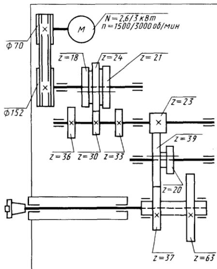
15. Напишите уравнение кинематического баланса для максимальной частоты вращения шпинделя
