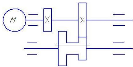
7. Пользуясь рисунком, напишите уравнения кинематического баланса для минимальной частоты вращения выходного вала коробки скоростей, определите минимальную частоту вращения
