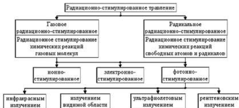
Рис. 2.11. Классификация процессов радиационно-стимулированного травления
