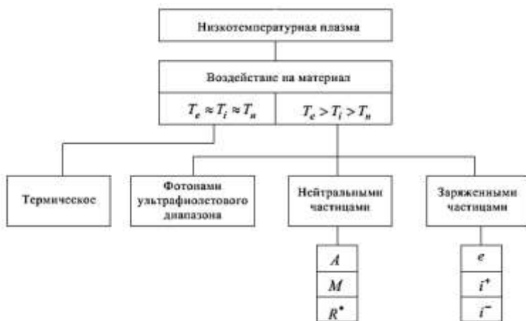
Рис. 1.2. Типы воздействия плазмы на обрабатываемый материал
