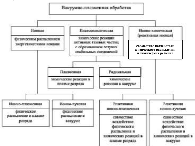
Рис. 2.2. Классификация плазменных технологических процессов по механизму воздействия на обрабатываемую поверхность
