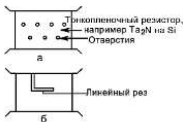
Рис. 4.3. Доводка резисторов: а - удаление материала на дискретных участках; б - удаление материала посредством линейных резов
