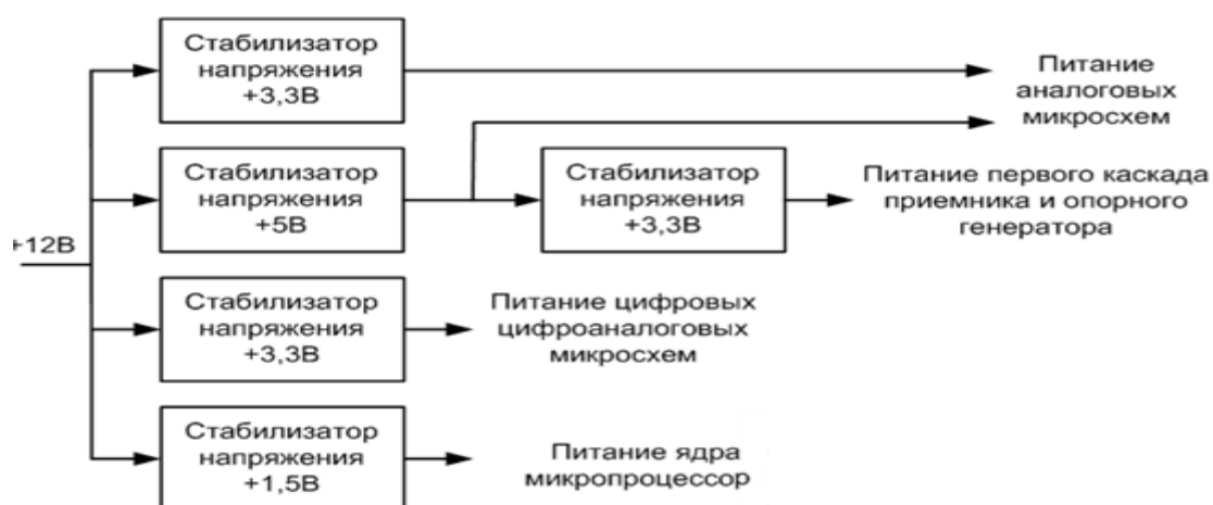
Рис. 14. Пример схемы питания материнской платы
