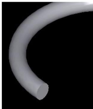
Рис. 11. Кинематическая операция вращения замкнутого контура
