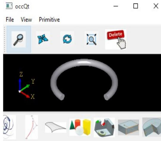
Рис. 13. Кинематическая операция построения модели вращением
