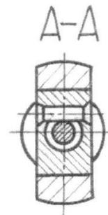
Вороток служит для вращения вручную метчиков, разверток и других инструментов, имеющих хвостовики с квадратным концом. Инструмент зажимается между неподвижной 3 и подвижной 2 призмами при помощи снабженной резьбой зажимной рукоятки 4. При вращении рукоятки 4 увлекают за собой призму 2 посредством штифта 7, входящего в кольцевую выточку нажимного конца рукоятки 4.
