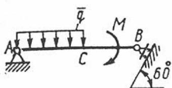
Определить момент  $M$  пары сил, при котором реакция опоры  $B$  равна 250 Н, если интенсивность распределенной нагрузки  $q = 150$  Н/м, размеры  $AC = CB = 2$  м.
