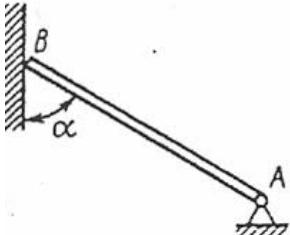
Конец  $B$  однородного бруса весом 100 кН, закрепленного в шарнире  $A$ , опирается на гладкую стену. Определить в кН давление бруса на стену, если угол  $\alpha = 60^\circ$ .
