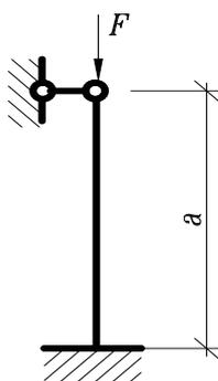
14. Какой коэффициент приведения длины следует принять в формуле Эйлера для данной схемы закрепления стержня:
