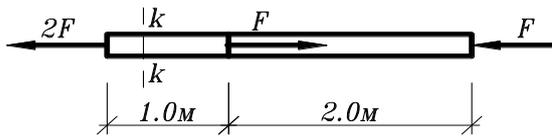
5. Определить напряжения в сечении k-k стержня, если
