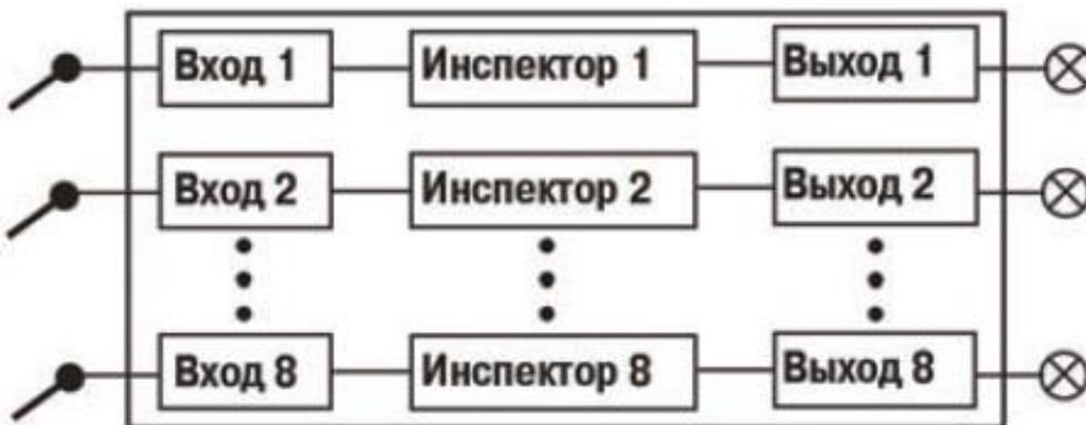
Рис. П.3.2. Принципиальная схема прибора модификации 2 прибора
