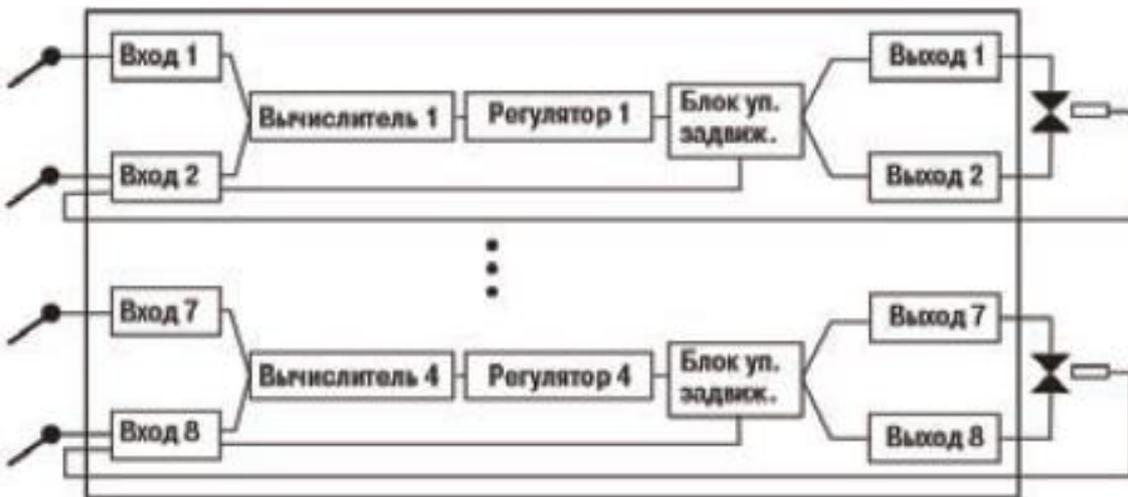
Рис. П.3.3. Принципиальная схема прибора модификации 3 прибора
