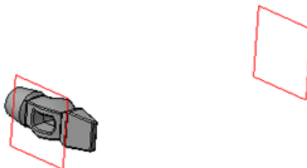
Рис. 11.23. Создание смещенной плоскости
