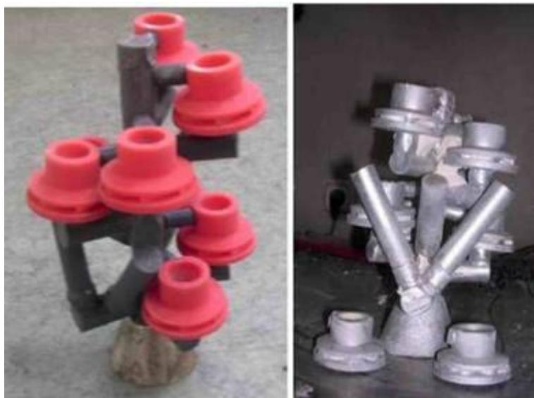
Рис. 7.4. Полистирольная модель и отливка
