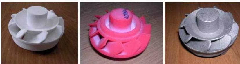
Рис. 7.5. Полистирольная модель (после выращивания и инфильтрации) и отливка (чугун)
