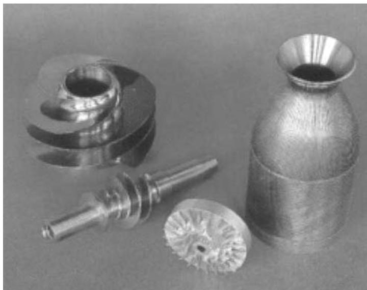
Рис. 7.1. Детали, целиком обработанные на станках с ЧПУ
