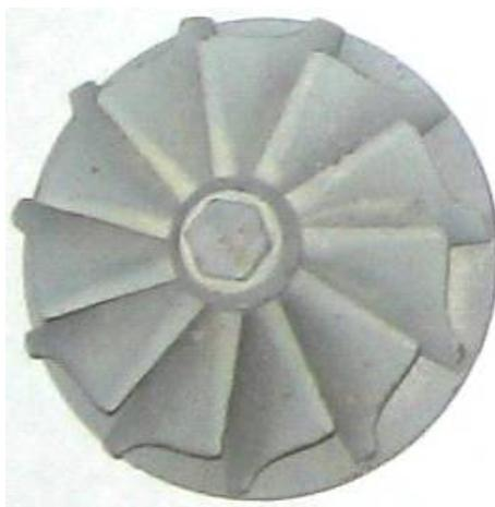
Рис. 1.3. Рабочее колесо компрессора агрегата турбонаддува
