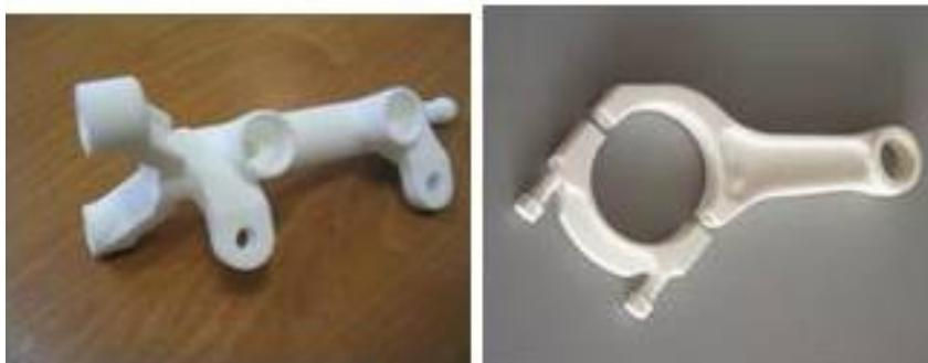
Рис. 7.8. Модели, полученные SLS
