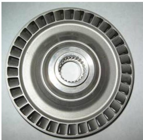
Рис. 1.6. Турбина с закрытыми узкими межлопаточными каналами, выполненными в цельной заготовке
