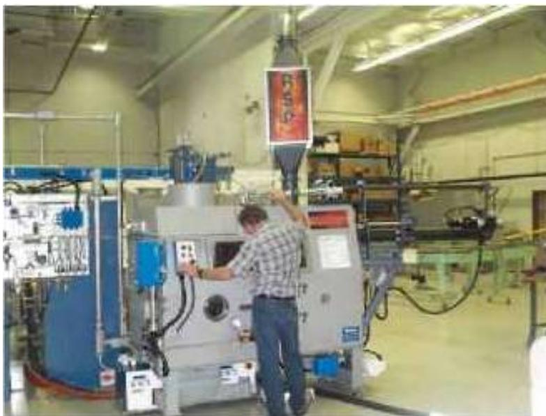
Рис. 7.12. Машина RSP для изготовления инструментальной оснастки
