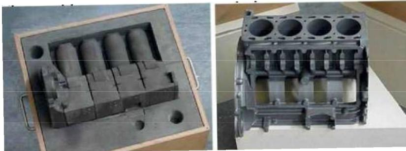
Рис. 7.10. Сборка формы и отливка (чугун)
