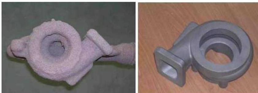
Рис. 7.7. Оболочковая форма и и отливка корпуса турбины, полученные по восковой синтез-модели
