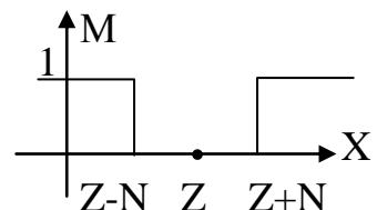
определяемого в результате сравнения задающего  $Z$  и фактического  $X$  сигналов с учетом зоны нечувствительности  $N$ . Входные сигналы, поступающие на схему вырабатываются по следующим правилам:
