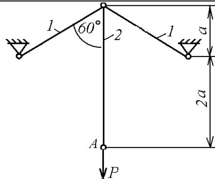
7. Определить площадь поперечно-го сечения стального стержня и перемещение точки A при  $[\sigma] = 160$  Мпа,  $P_1 = 20$  кН,  $P_2 = 20$  кН, если  $E = 2*10^5$  Мпа,  $a = 0.5$  м.
