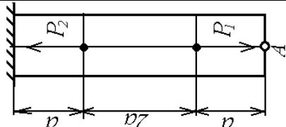
8. Определить допускаемую нагрузку  $P$  на систему симметричную систему стержней, если  $E_1 = 2*10^5$  Мпа,  $F_1 = 10$  см $^2$ ,  $E_2 = 10^5$  Мпа,  $F_2 = 20$  см $^2$ ,  $[\sigma]_1 = 160$  Мпа,  $[\sigma]_2 = 60$  Мпа.
