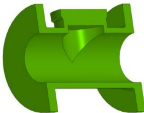
Рис. 2.12. Результат операции «Вырезать выдавливанием»
