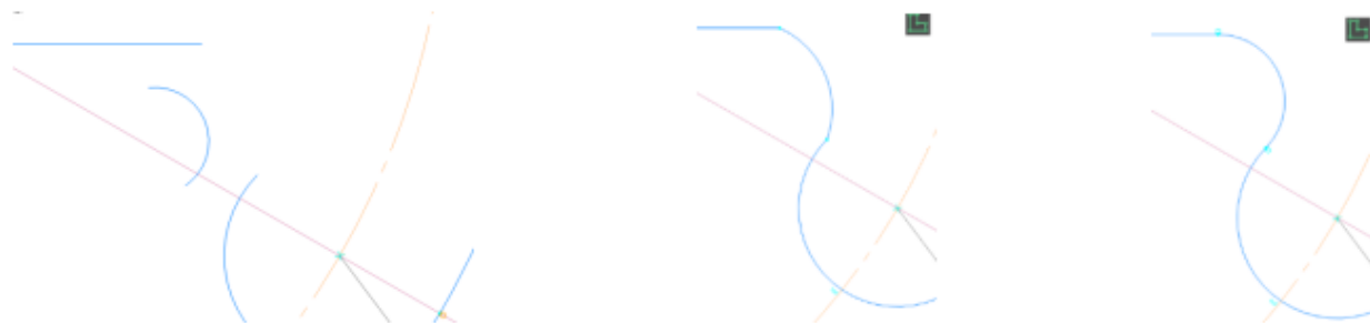
Рис. 1.12. Этапы построения сопряжения: (слева) – дуга радиуса 15 мм, прямая, дуга радиуса 10 мм; (по центру) – ограничение «Объединить точки»; (справа) – ограничение «Касание»
