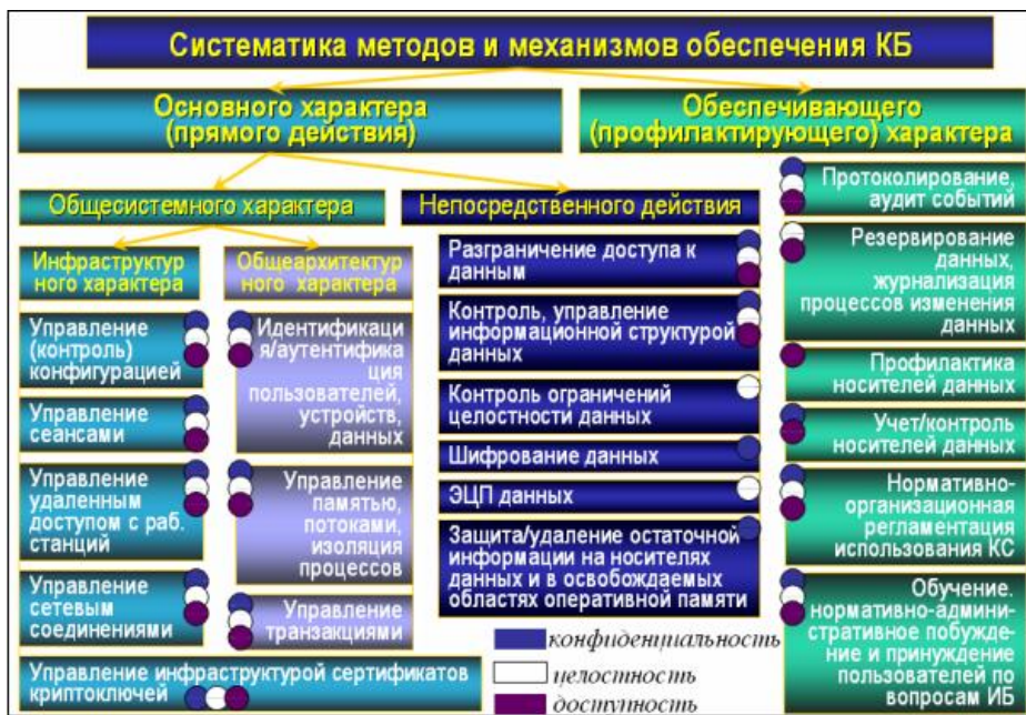
Рис. 1.1. Систематика методов и механизмов обеспечения компьютерной безопасности
