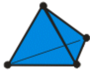
Четырехгранный элемент (4 узла)
