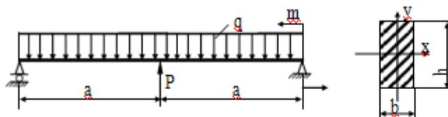
Задача 7. Стальная балка прямоугольного поперечного сечения ( $h = 20$  см,  $b = 10$  см) нагружена силой  $P$  и равномерно распределенной нагрузкой интенсивностью  $q$ . Определить допускаемую величину  $q$ , если  $a = 2$  м;  $[\sigma] = 120$  Н/мм<sup>2</sup>.
