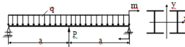
Задача 6. Проверить прочность балки, если  $[\sigma] = 160$  МПа. Принять  $a = 2$  м;  $q = 4$  кН/м;  $P = 20$  кН;  $m = 30$  кНм;  $h = 20$  см;  $b = 12$  см.
