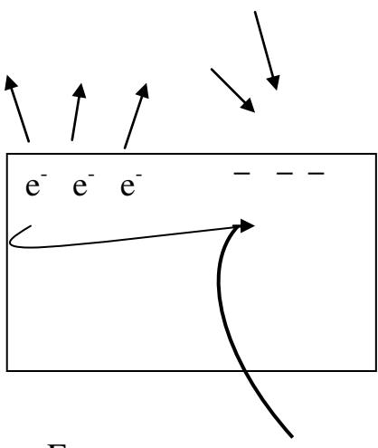
Схема электрохимической коррозии железа в кислой среде
