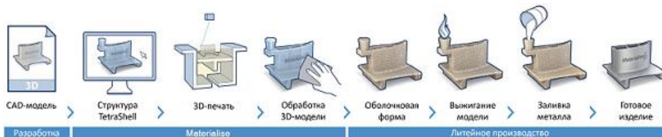
Рис. 2. Технологический процесс литья по выжигаемым моделям
