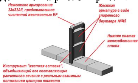
Рис. 3. Схема участка конечно-элементной модели №1 в ПК «ЛИРА-САПР»
