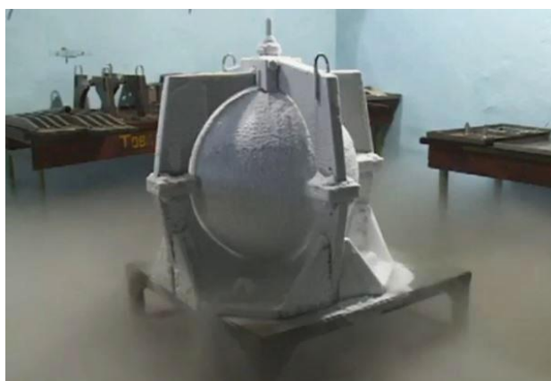
Рис. 3. Испытанный в жидком азоте шаробаллон
