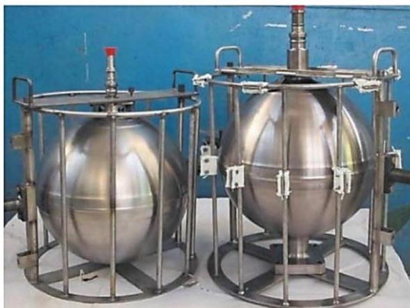
Рис. 4. Готовые титановые шаробаллоны
