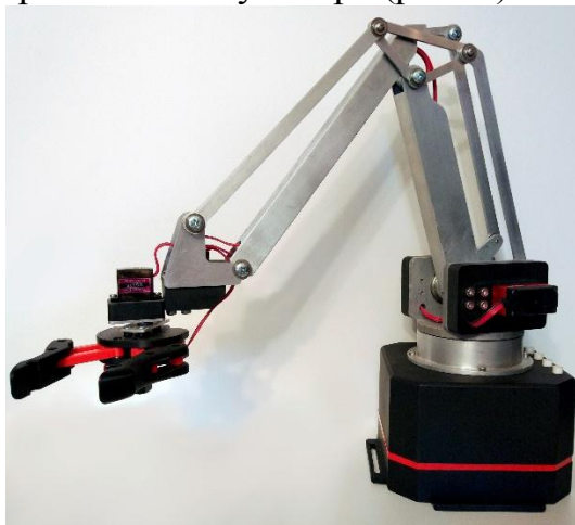
Рис. 2. Прототип лабораторного манипулятора
