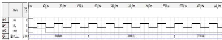
Рис.1.44. Тестирование умножителя на примере умножения 5x5. Результат 25
