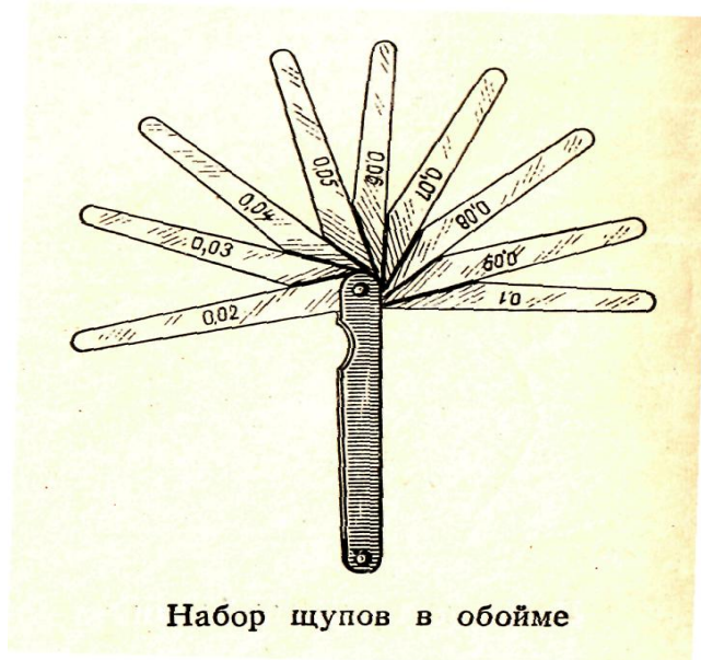
Рис. 6.6. Измерение зазоров при помощи щупа
